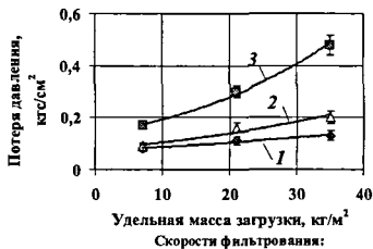
Рисунок 10 - Изменения потерь давления в зависимости от скорости фильтрования (а) и удельной массы волокна (б)
