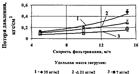
Рисунок 10 - Изменения потерь давления в зависимости от скорости фильтрования (а) и удельной массы волокна (б)
