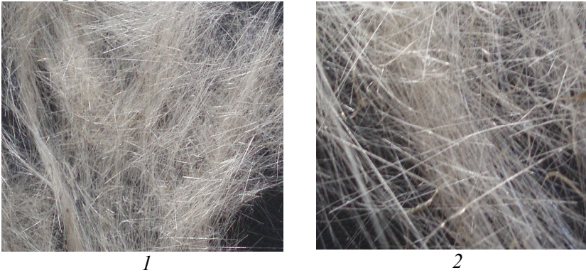
Рисунок 8 – Волокна, изготовленные с использованием струйной головки: 1 – из золы; 2 – из отходов горючих сланцев (увеличение \times 300 )
