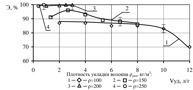
Рисунок 4 – Зависимость эффективности (Э) от удельного объема воды (V уд ) при очистке от взвесей на воздушном волокне
