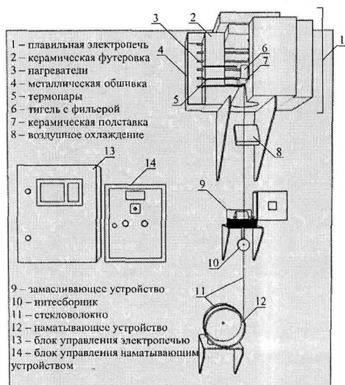
Рис. 1 Схема лабораторной установки для получения непрерывного волокна.
