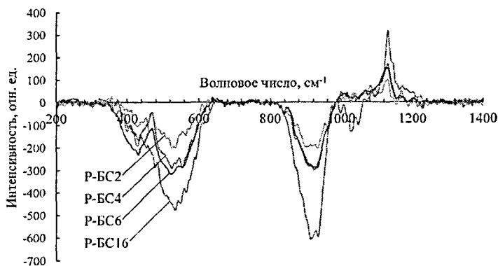
Рис. 15 Разностные кривые, полученные вычитанием из КР-спектров фосфорсодержащих стекол спектра стекла, не содержащего P_2O_5 .
